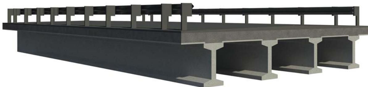
La trave TI 120 viene utilizzata per la realizzazione di impalcato da ponte di grandi luci ( $L_{max} = 22$  metri). Le travi TI 120 possono essere posizionate ad interasse variabile. L'impalcato viene completato con il posizionamento delle lastre predalles tra una trave e l'altra. Lo spessore della soletta e dei traversi, e le relative armature aumentano proporzionalmente all'interasse delle travi.
